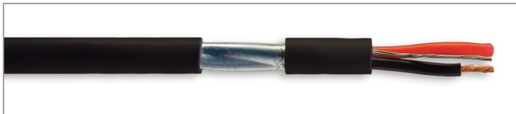
*Conductor de cobre electrolítico, flexibilidad clase V, aislamiento PVC, formación por pares, pantalla de aluminio/poliéster al 100% de cobertura más hilo de drenaje sobre el conjunto de los pares, cubierta exterior PVC, color negro.*
